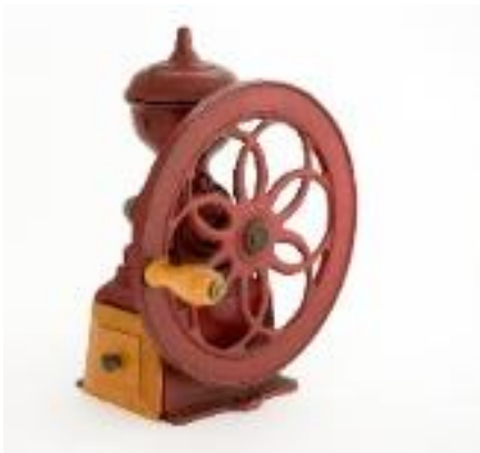
Objekt 20 Grosse Übersetzung für leichtes Mahlen.
