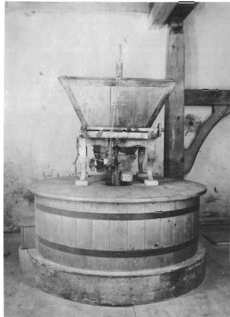
Ein Mahlgang. Die im Innern liegenden Mahlsteine werden von der kreisförmigen Holzzarge abgedeckt. Darüber befinden sich der Vorratstrichter und die Fördereinrichtung für den Zulauf des Mahlgutes. Ganz links unten der Auswurfkasten für das durchgelaufene Mahlgut. Rechts im Hintergrund ein Teil des Krans. Foto: M. Paeckelmann
